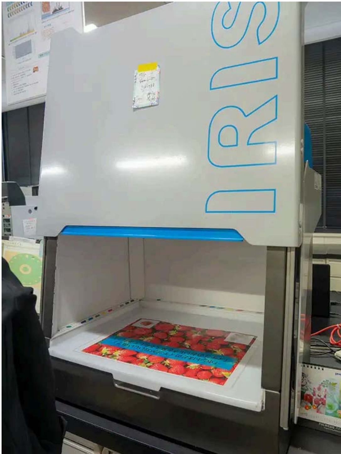
使用IRIS視覺感測器分析各類水果顏色。(圖/嘉南藥理大學 提供)
