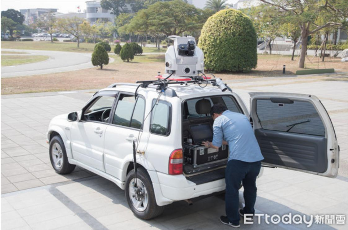
▲3D環景雷射掃描儀搭載於車頂，實際巡迴嘉藥校園掃描，所到之處引起師生矚目。(圖/嘉藥提供)
