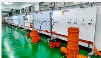
↑ 下水道用戶排水設備配管實習設備
