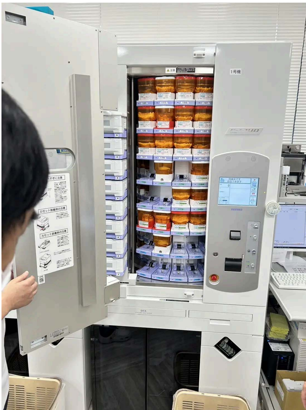
日本藥師使用自動包藥機，減低藥師常規調劑作業時間(圖/嘉南藥理大學藥學系 提供)
